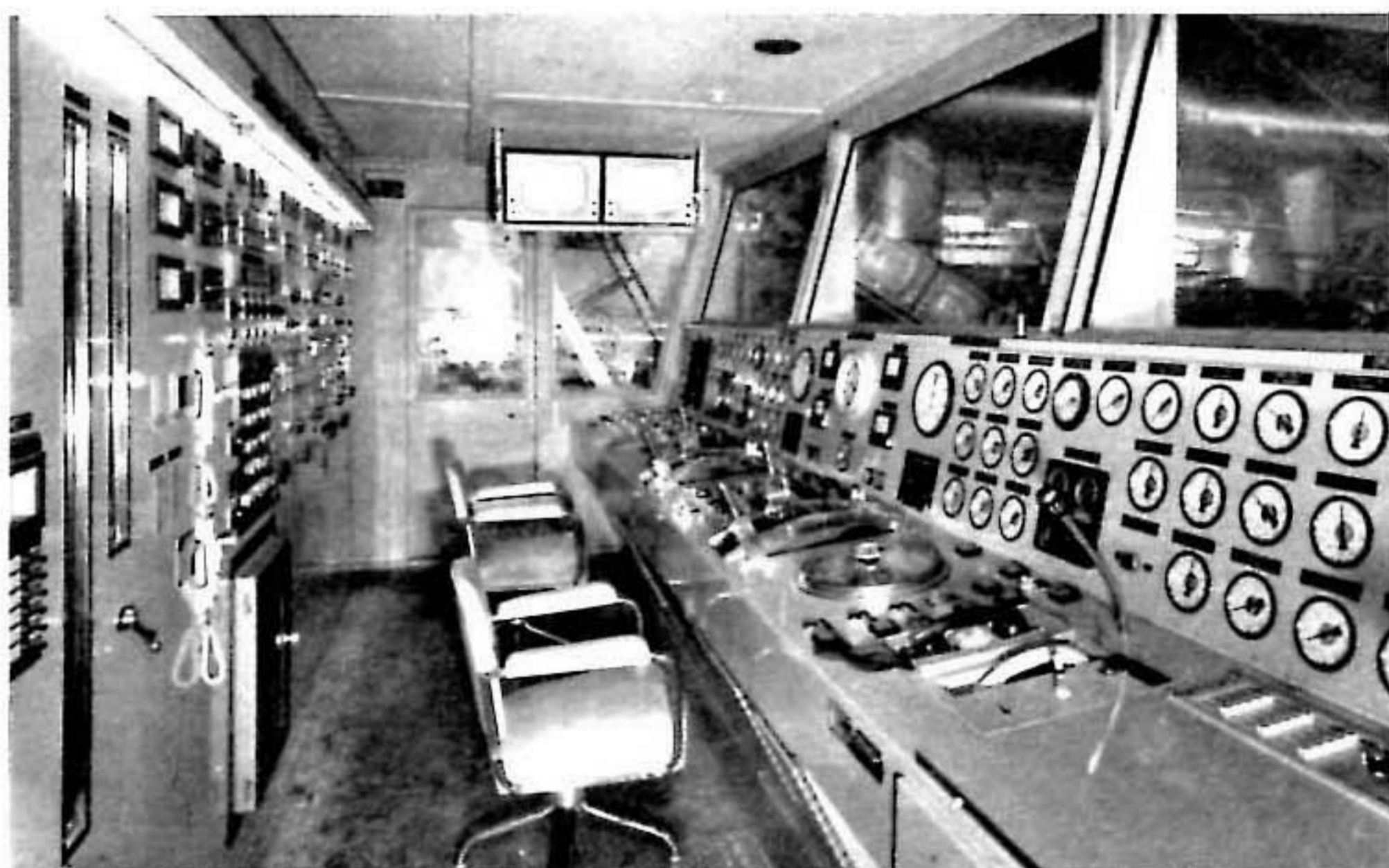
Dans ce poste insonorisé, l'officier mécanicien de quart surveille toutes les machines. Deux écrans de télévision lui permettent d'observer tout directement et de suivre les indications du poste de navigation.
