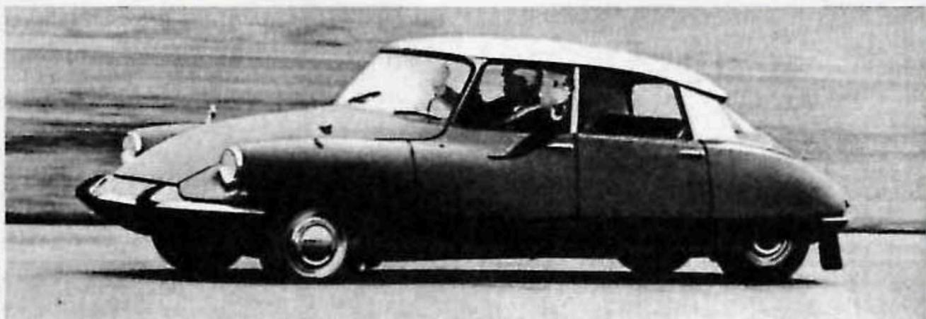
**AFIN** de démontrer que la notion de sécurité n'est pas un vain mot chez Citroën, une DS 21 roulant à plus de 120 km/h est passée sur une lame aiguisée. Après éclatement du pneu, le conducteur a lâché le volant et freiné brutalement. La voiture s'est arrêtée en ligne sans dévier de sa trajectoire.
