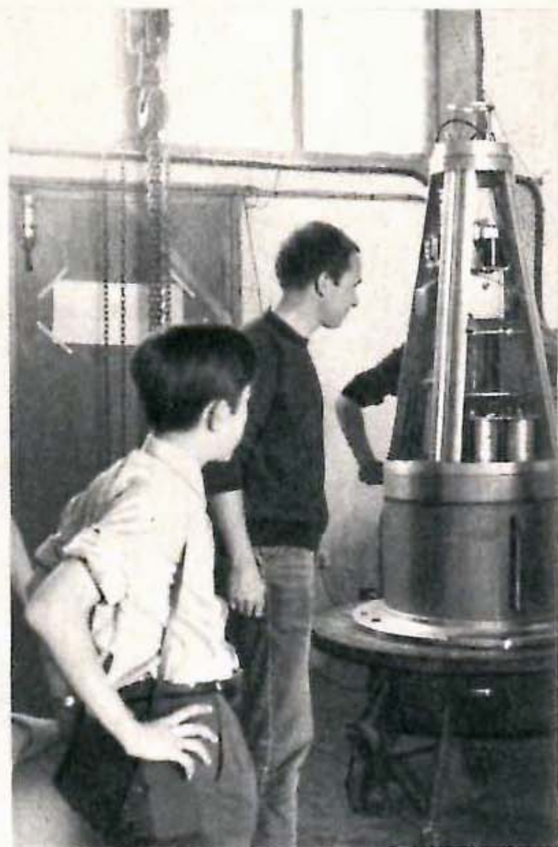
— Mise en place des instruments de mesure dans la tête de la fusée
