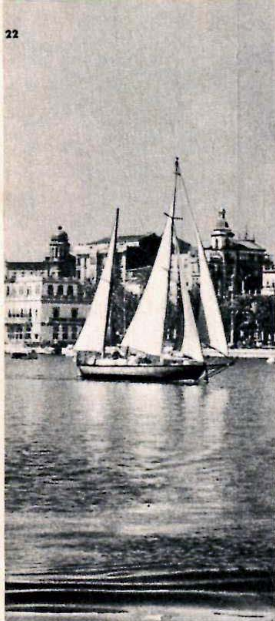
« Joshua ». Les mâts sont faits avec des poteaux électriques. Outre le prix de revient très bas Bernard considère que c'est là le matériel idéal.
