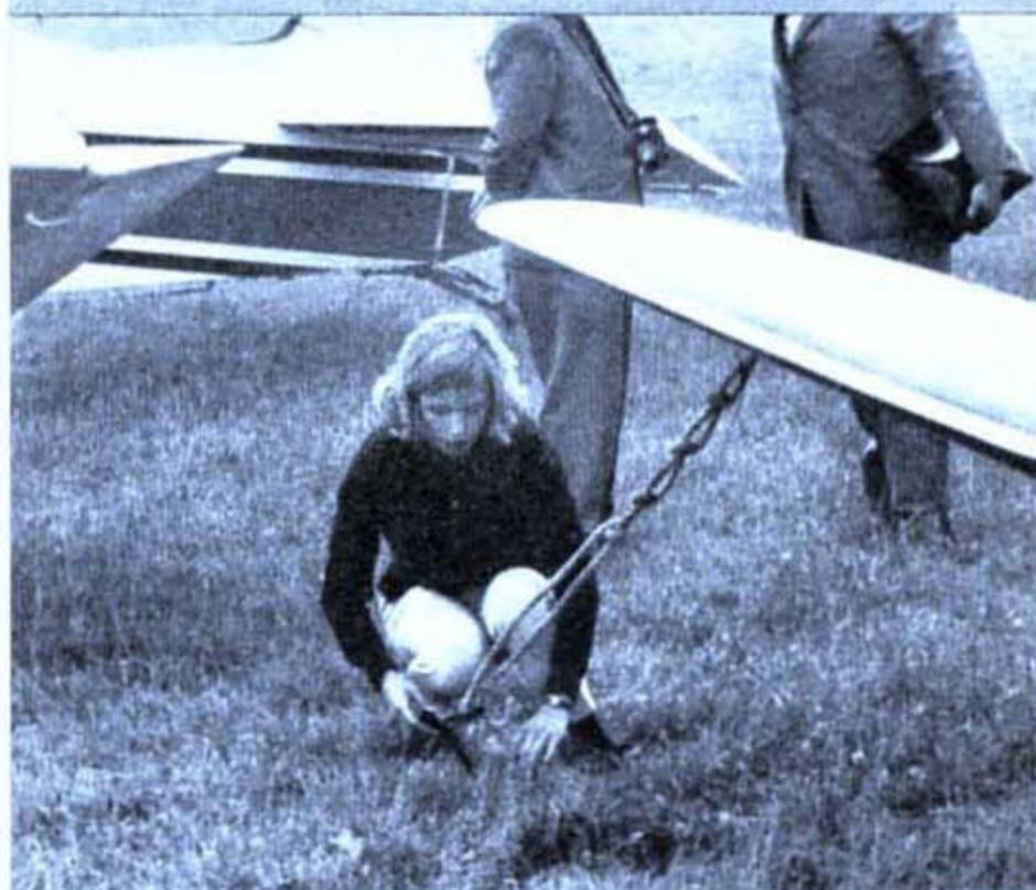
Ancrage de l'avion au sol, afin qu'il résiste au vent.
